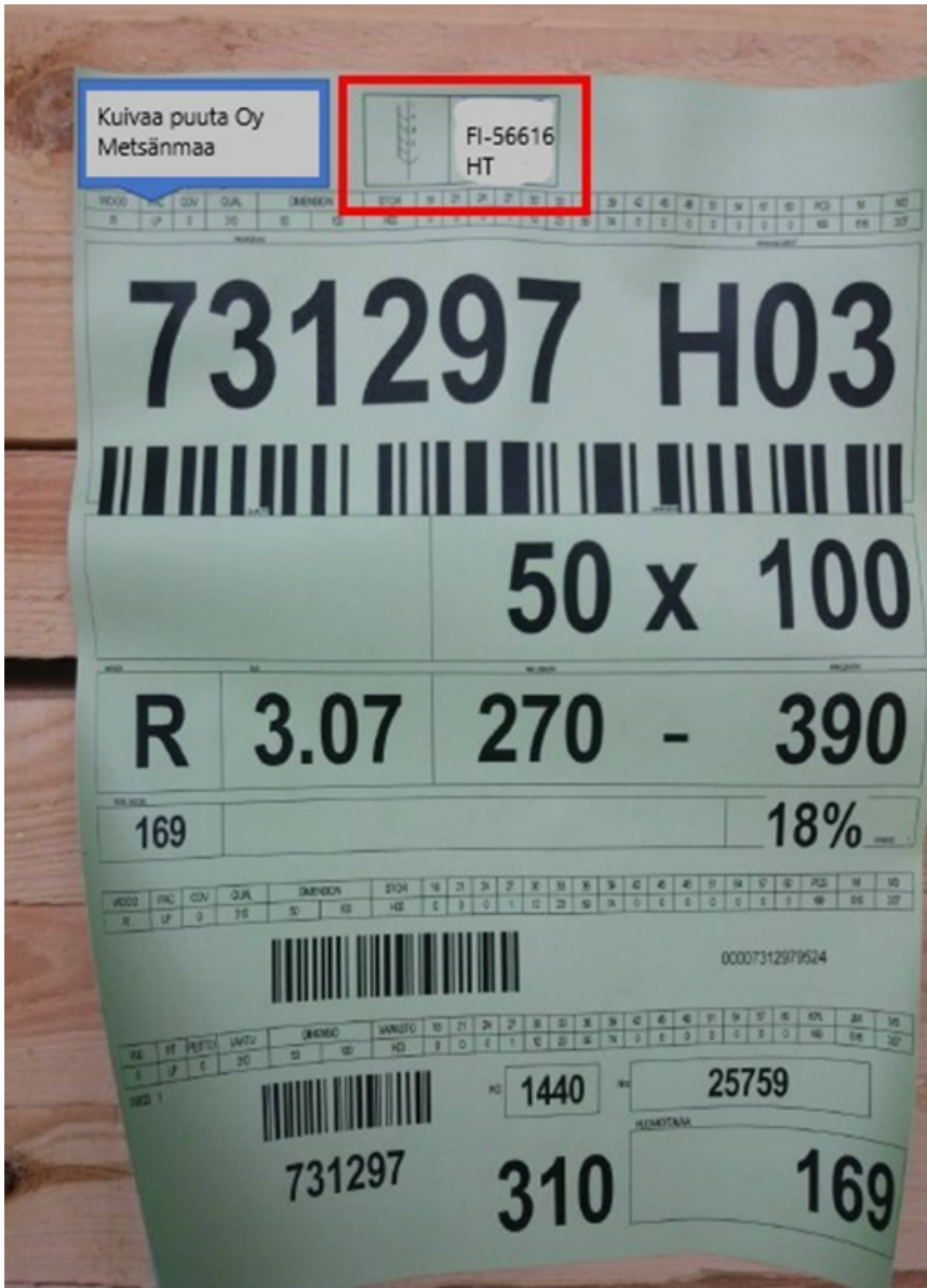
Pakettiseteli sahatavaranipussa ISPM 15 -merkinnällä (FI -56616 HT on kuvitteellisen yrityksen merkintämalli)
