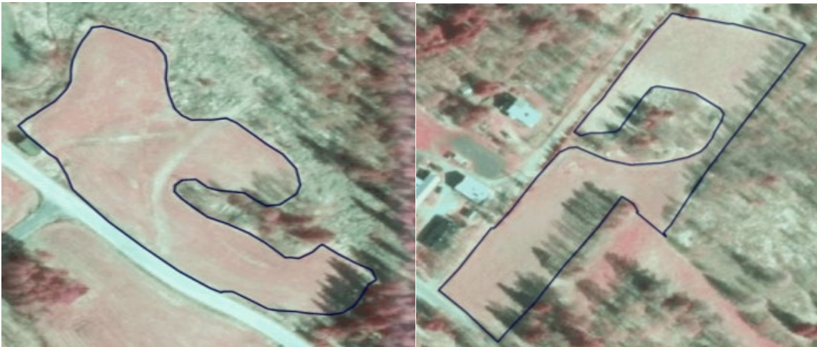
Kuva 1. Kehämitta mitataan lohkon reunojen mukaan.
